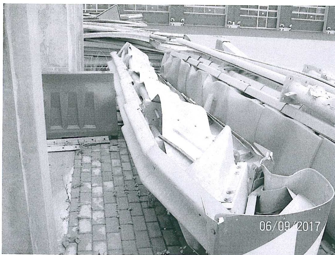
Poduszka zderzeniowa – urządzenie składające się w 1/3 z elementów stalowych i 2/3 z elementów plastikowych szt.1 waga około 400 kg.
